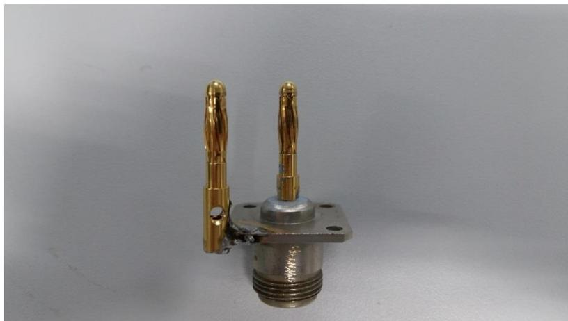
Bild III.1e - Eigenbauadapter für Typ N-Verbindungskabel
