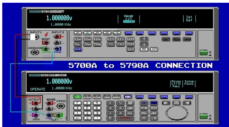
Bild IV.1.3.2 schematische Einstellung von Normal und DUT am Beispiel von Fluke 5700A als Messobjekt
