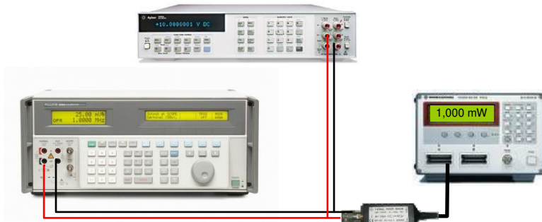
Bild XIII.2.8.2.3 – Bestimmung des DC-Korrekturfaktors des Leistungsmesskopfes am DMM
