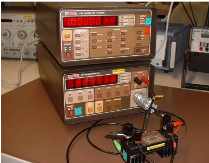
Bild XV.2 - Millivoltkalibrierung an Stromquelle Keithley 263: An der Quelle eingestellt sind 10 \mu\text{A} an 100,0019 \Omega . Mit dem korrigierten Wert aus dem Kalibrierschein (9,99884 \mu\text{A} ) ergibt sich rechnerisch eine Spannung 0,999902 mV. Das eigene Nanovoltmeter zeigt 0,99997 mV. Die Ergebnisse dieser Vergleichsmessungen werden als Reproduktionsauswertungen im Messunsicherheitsbudget berücksichtigt.
