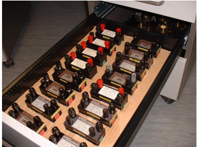
Bild XV.1 Festwiderstände Burster 1240. Anschluss in 4-Draht Technik
