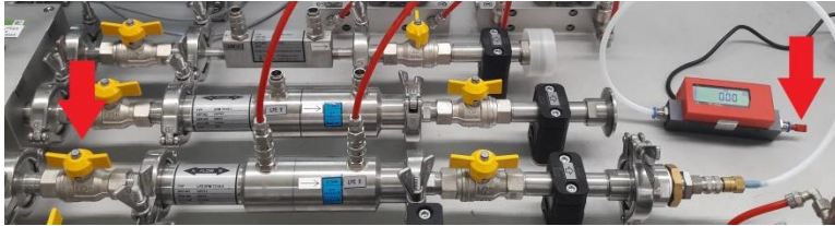
Abbildung 11 LFE Eingang offen, DUT Ausgang geschlossen
