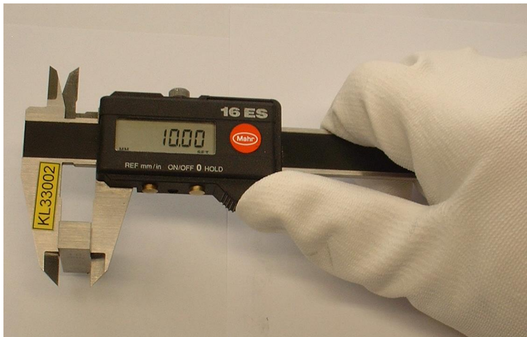
Bild L.IV.1 Kalibrierung eines Messschiebers
