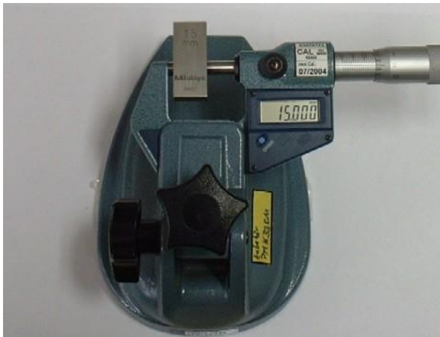
Bild L.V.1 Kalibrierung einer Bügelmessschraube
