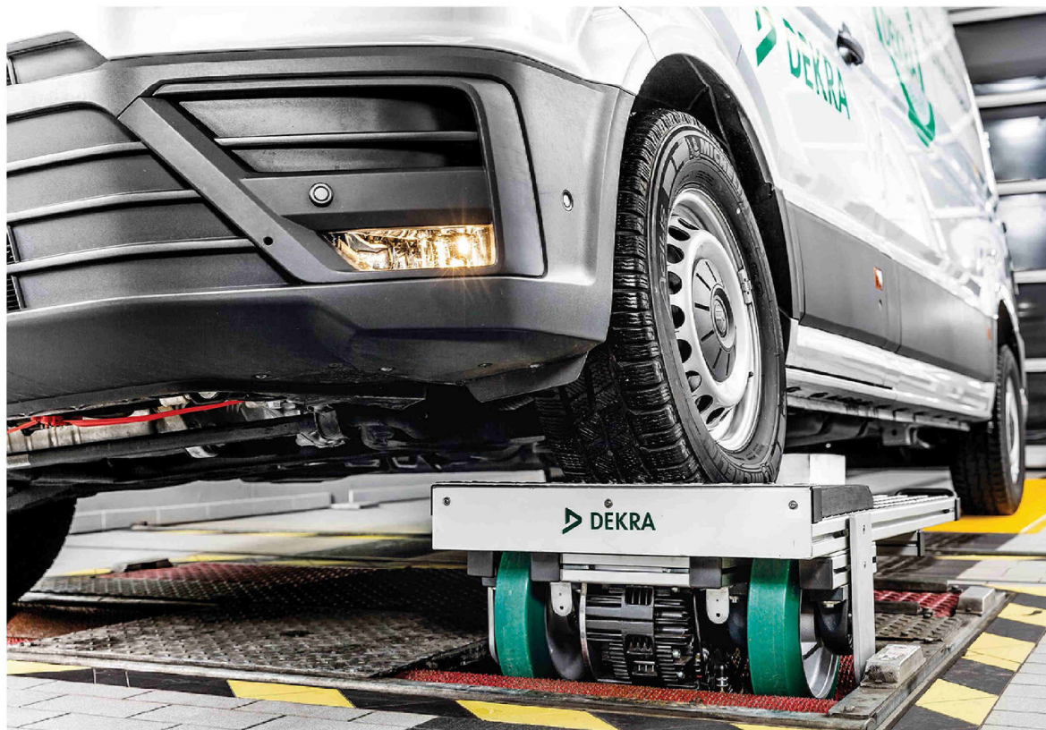
BILD 1 Dynamische Kalibrierung eines Rollenbremsprüfstands (© DEKRA)
