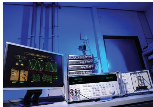
Ein kommerzieller Präzisions-Kalibrator (Bildmitte) wird durch das AC-Quantenvoltmeter im Wechselspannungsmodus kalibriert.
